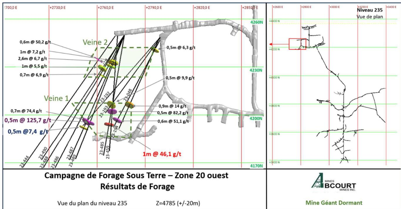
La campagne de forage dans la zone 20 ouest est terminée. Nous sommes en attente des résultats des derniers trous de forage pour finaliser l'interprétation et la modélisation tridimensionnelle du chantier planifié. Les forages se poursuivent sous terre au niveau 235 dans la zone 3 sud.
