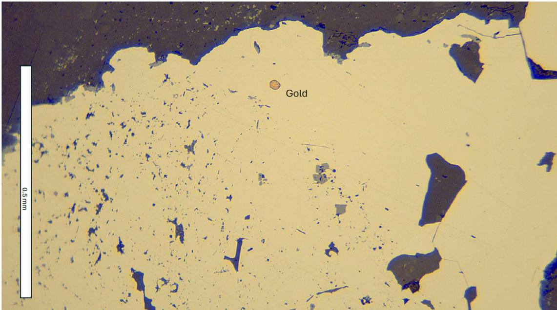
Figure 3. Grain de pyrite observé en lumière réfléchi (microscope pétrographique). Notez le cœur riche en inclusions (silicates et magnétite) de la pyrite et sa partie extérieure pauvre en inclusions et contenant un grain d'or.
